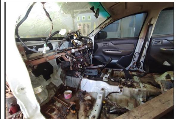
Seluruh isi mobil termasuk Kursi dan interior lain, dashboard, electrical dan control di lepas untuk perbaikan body dan juga perbaikan dudukan dalam mobil yang rusak.
