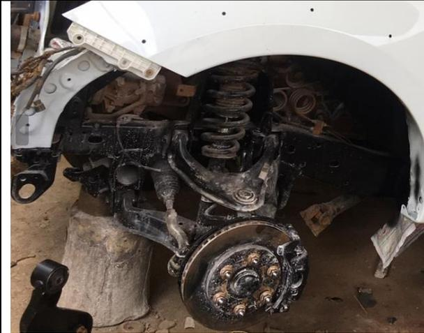
Penggantian seluruh komponen yang rusak, terkhusus yang ada pada bagian kiri Depan : Bar Stabilizer dan Tie Rod, Sayap Kiri Atas, Sayap Kiri Bawah, Suspensi, Cylinder Koupling Bawah, Velg, Hub, dan semua komponen lain yang rusak.
