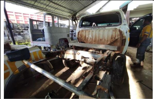
Bak belakang dipisahkan dari Frame dan Body Utama untuk proses perbaikan (Ketok / Repair dan Dico).
